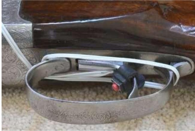
Enrolle el interruptor del gatillo lo más fuerte posible y enrolle el cable sobrante alrededor del guardamonte. Coloque el interruptor de modo que la cola de goma no interfiera con el dedo índice; esto es diferente para tiradores zurdos y diestros.
